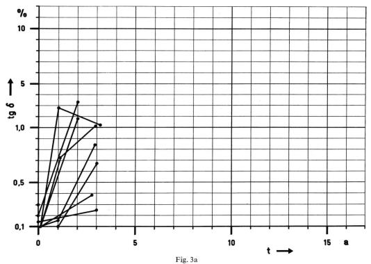
Kontrolle des Isolieröles aus 380-kV-Transformatoren Verlustfaktor in Abhängigkeit der Betriebsjahre tg δ Verlustfaktor bei 90 °C; t Zeit; a Betriebsjahre
