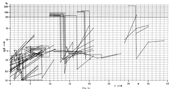
Kontrolle des Isolieröles aus 150-kV-Transformatoren Verlustfaktor in Abhängigkeit der Betriebsjahre
