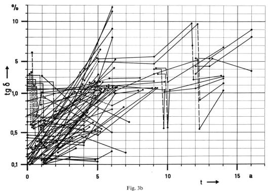
Kontrolle des Isolieröles aus 220-kV-Transformatoren Verlustfaktor in Abhängigkeit der Betriebsjahre tg δ Verlustfaktor bei 90 °C; t Zeit; a Betriebsjahre
