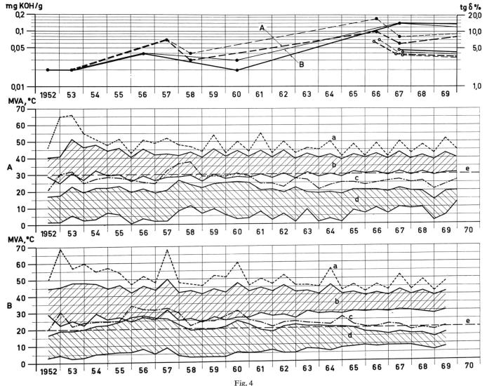
Kontrolle des Isolieröles aus 30-MVA-Transformatoren 150/8 kV und 20-MVA-Transformatoren 50/8 kV
