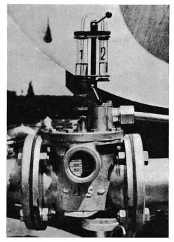
Fig. 8 Gasanalysator
