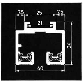
für bewegliche Beleuchtungs-Installationen in Schaufenstern, Ladengeschäften, Warenhäusern, gleichzeitig verwendbar als Tragkonstruktion für herabgehängte Decken
