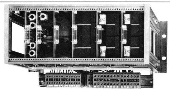
Kartenmagazin mit Regel- und Leistungselektronik-Steckkarten Typ G 21: 5 kW, 220 V, 1ph. Typ G 32: 15 kW, 380 V, 3ph.
