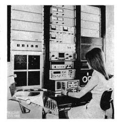
auch die Fehlersuche an defekten Schaltungen und erstellt Qualitäts- und Produktionsstatistiken. Das gerätemässige Konzept besteht darin, über eine Relais-Schaltmatrix den Prüfling mit den Prüfgeräten zu verbinden.
