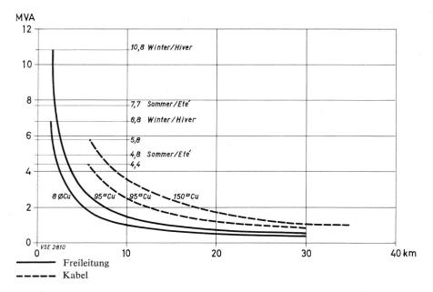
Fig. 1 **Ubertragungskapazität von Leitungen und Kabel** (13 KV) Einzellast in x km Distanz von der Trafostation  $\cos \varphi = 0.86 \quad \Delta U_{max} = 3 \%$
