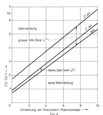
Meldekennlinie des Grenzwertmelders bei konstanten Frequenzen  $2f_{\rm I}\ {\bf und}\ 2\ p\cdot n$  Bei  $f_{\rm I}=50\ {\rm Hz}$ ist die Differenz  $2f_{\rm I}-2\ p\cdot n$  in Hz zahlengleich mit Schlupf s in %
