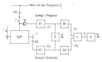
Fig. 1 Prinzipieller Aufbau einer Einrichtung, die unmittelbar den Schlupf überwacht
