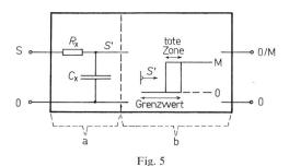
$(f_1 - f_2)$  schnell folgt. Die Funktion der ganzen Anlage zur Schlupfüberwachung von Synchronmaschinen erfordert, dass statt der Spannung S die mit einstellbarer grösserer Zeitkonstante  $T_x = R_x C_x$  folgende Spannung S' mit dem eingestellten Grenzwert verglichen wird (Fig. 5).
