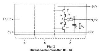
a Impulsformer; b monostabiler Multivibrator; c Leistungsstufe T', T'' abwechselnd stromführende Transistoren; R', R'' (betragsgleich) Schutzwiderstände; C Glättungskondensator;  $R_1$  Vorwiderstand;  $R_9$  Bürde
