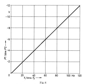
Stationäre Kennlinie der Digital-Analog-Wandler  $f_1$  bzw.  $f_2$  Frequenz der ansteuernden Impulsfolge; P1 bzw. P2 Mittelwert der Ausgangsspannung
