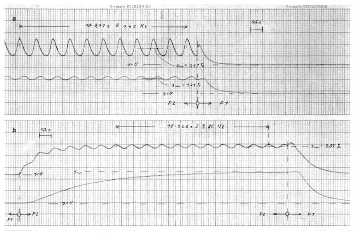
Fig. 10 Ungleichmässig schlüpfende Maschine
