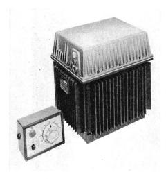
Dieses arbeitet nach folgendem Prinzip: Die Netzspannung wird über eine Diodengleichrichterbrücke mit nachfolgendem Spannungsregler in eine veränderliche Gleichspannung umgeformt. Diese Gleichspannung speist über einen Messkreis den Wechselrichter, der die Gleichspannung wieder in eine dreiphasige Wechselspannung mit variabler Frequenz umformt. Die variable Frequenz ist dabei abhängig von der Höhe der Spannung.
