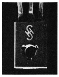
in der bisher üblichen Planartechnik durch wesentlich grössere Sicherheit gegen thermischen Durchbruch aus. Weitere Vorteile sind ihre geringe Sättigungsspannung und die hohe Grenzfrequenz. Die Technologie ermöglicht vor allem auch die Herstellung komplementärer Si-Transistoren (PNP / NPN) für den NF-Bereich.
