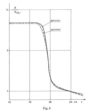
Betatronmagnet, Induktionsverlauf in der Bahnebene
