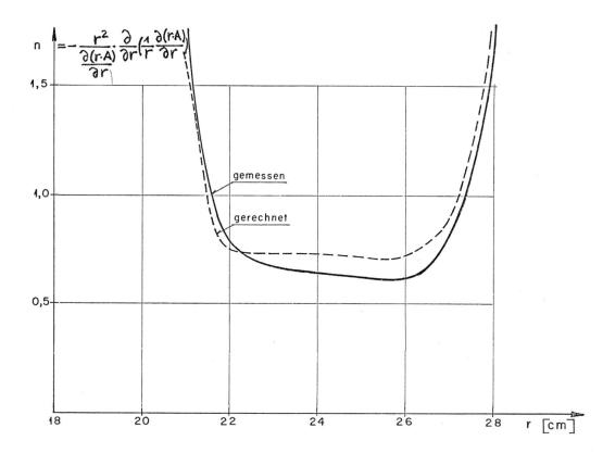
In Fig. 8 wird ein Vergleich zwischen gemessener und gerechneter Induktion auf der Bahnebene der Elektronen in einem Betatron in Abhängigkeit vom Abstand von der Bahnachse gezeigt. Sollkreisradius der Bahn ist 24,5 cm, alle Induktionen sind auf die Induktion  $B_{24.5}$ des Sollkreises bezogen. Diese Abhängigkeit wurde ermittelt, um zu prüfen, ob die Wideröesche Bedingung erfüllt ist, nach der die Induktion  $B_{24,5}$  die Hälfte der mittleren Induktion innerhalb des Sollkreises sein muss.
