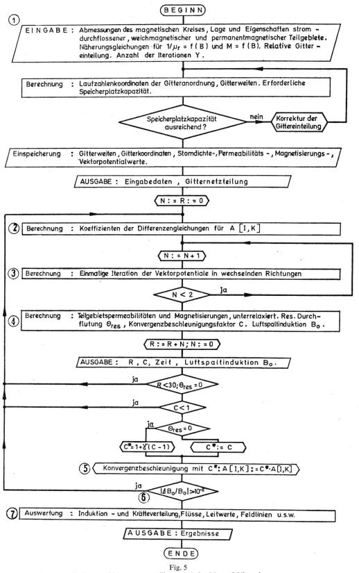
Rechenmaschinenprogramm für numerische Magnetfeldberechnungen
