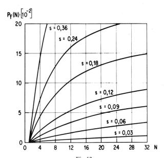
Fig. 12 Fehlerwahrscheinlichkeitsverteilung  $P_{\mathbf{f}}(N)$  in Funktion der Anzahl gleichzeitig übertragener und die gleiche Auftrittswahrscheinlichkeit eines Schwarzpunktes s aufweisenden SW-Bilder N
