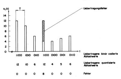
Fig. 20 Simulation einer PCM Bildübertragung  $300 \times 300$  Bildpunkte, n=4 bit/Abtastwert
