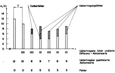
Fig. 21 **Prinzip einer DPCM Übertragung** m=2 bit/Abtastwert
