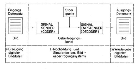
Fig. 3 Simulation eines Bildübertragungssystems auf dem Digitalrechner
