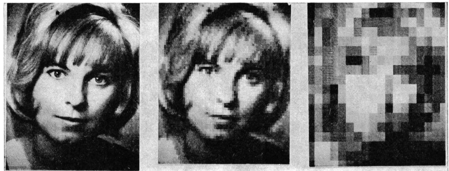
Fig. 18 Bildqualität als Funktion der Anzahl Bildpunkte N a N = 576 \times 576 b M = 144 \times 144 c N = 18 \times 18
