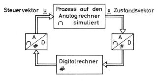
Fig. 12 «On-Line» Control auf dem Hybridrechner
