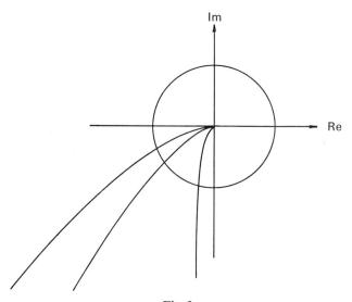
Fig. 6 Frequenzgangkurven des kompensierten Systems
