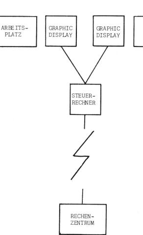
verlangte Bildausschnitte, ohne Rückfrage an den zentralen Rechner beantworten. Oft können überhaupt ganze graphische Programme vom Steuerrechner ausgeführt werden. Dazu besteht oft die Möglichkeit, mehrere Displays von einem einzigen Steuerrechner aus zu bedienen. Fig. 9 zeigt einen IBM 2250 Graphic Display mit einem IBM 1130 Steuerrechner.
