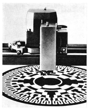
Fig. 2 Schneiden einer Codierscheibenmaske auf dem Zeichentisch
