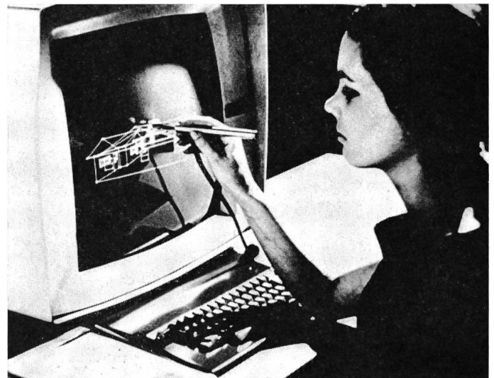
Fig. 9 Graphic Display IBM 2250 angeschlossen an einen Steuerrechner
