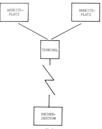
Fig. 3 Arbeitsablauf bei der Verarbeitung über ein Terminal
