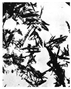
Fig.~2 Elektronenmikroskopische Aufnahme von ZnO, das durch Entladung einer amalgamierten Zinkpulver-Elektrode in 42,7 % KOH + 8,4 % ZnO bei 18 mA/g gebildet wurde
