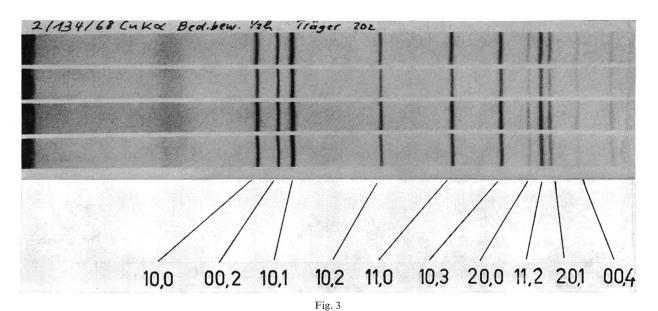
Guinier Röntgendiagramme einer entladenen Zn-Elektrode, CuK-d-Strahlung
