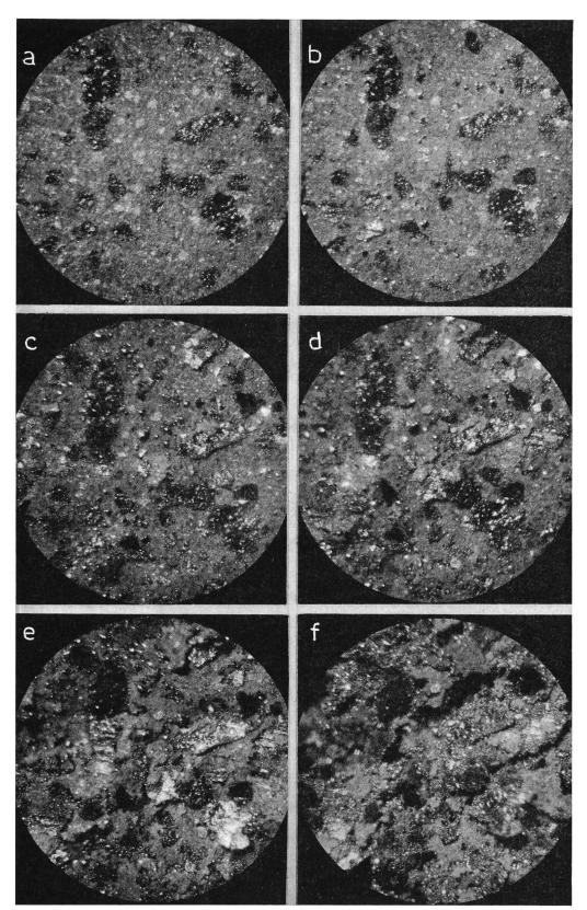
Quecksilberoxydelektrode bei Entladung mit 7 mA/g in 40 % KOH Insitu Aufnahmen mit transparenter Plexiglaszelle Vergrösserung 45 × a nach 0 h, b nach 1 h, c nach 3 h, d nach 8 h, e nach 15 h, f nach 31 h Entladung Aus der Art und Weise wie die Quecksilbertröpfchen an schwarzen Graphitteilchen und auf den weissen Silberteilchen. welche den Leitfähigkeitszusatz bilden, entstehen und wie sich das Quecksilberoxyd auflöst, kann geschlossen werden, dass die Reak-
