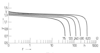
Fig. 9 Entladungskurven eines Elementes für Rufempfänger bei verschiedenen Entladewiderständen
