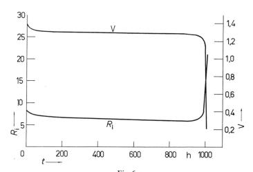
Fig. 6 Entladungskurve einer Uhrenbatterie (Durchmesser 11,5 mm, Höhe 3,5 mm) und Verlauf des innern Widerstandes  $R_i$  in Abhängigkeit vom Entladezustand, bei Entladung über 9300  $\Omega$
