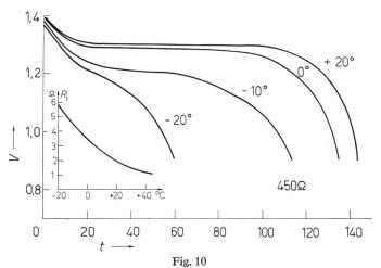
Entladecharakteristik einer Zelle mit Spezialelektrolyt für tiefe Temperaturen und Abhängigkeit des inneren Widerstandes R<sub>i</sub> von der Temperatur Durchmesser 15,5 mm, Höhe 5,9 mm
