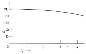
Fig. 7 Kapazitätsverlust einer Uhrenbatterie (Durchmesser 11,4 mm, Höhe 3,5 mm) durch Selbstentladung bei 20 °C
