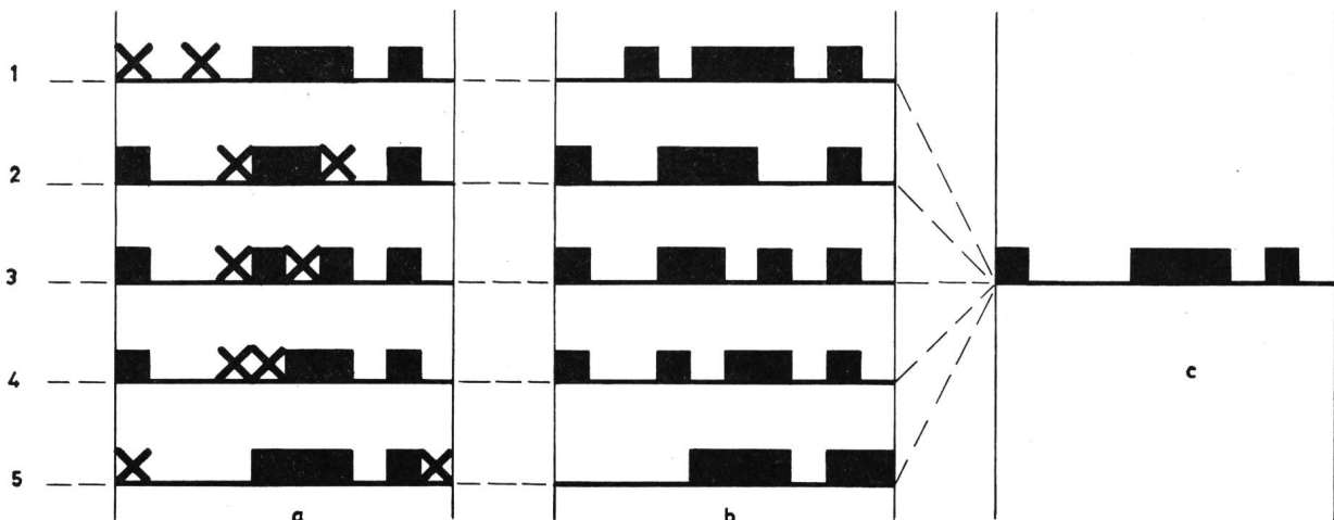
Fig. 3 Beispiel der Empfängereinstellung und der verwendeten Befehle zur individuellen und gemeinsamen Steuerung durch einen Sammelbefehl für eine Gruppe von 5 Empfängern
