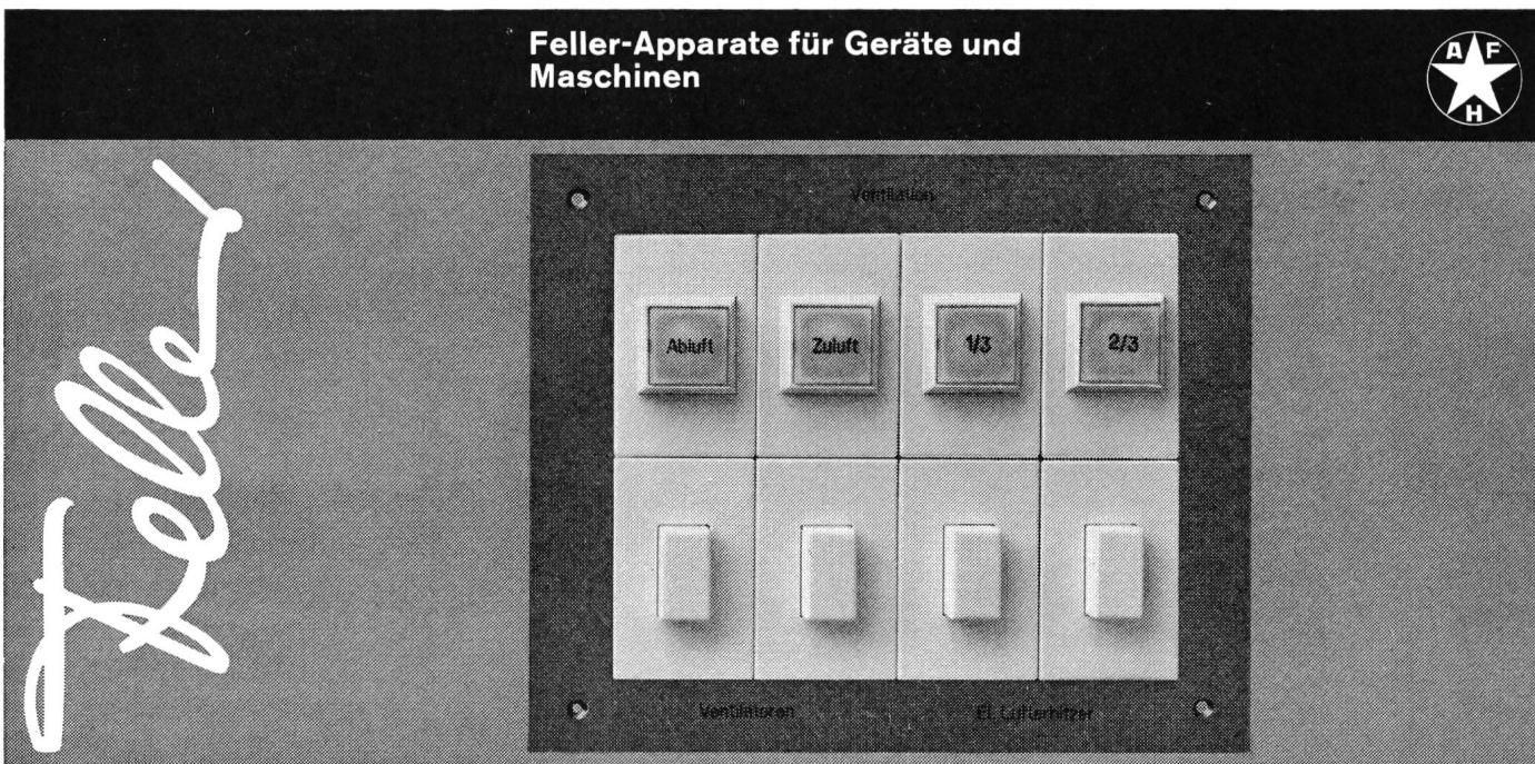
Feller-«FLF»-Apparate lassen sich zu kleinen, eleganten Kombinationen zusammenstellen. Die durch blosses Einschnappen rasch montierten Apparate können als Druckschalter, Druck-Impulskontakte, Signallampen und Steckdosen, Typ 12 und 13, geliefert werden. Geben Sie uns Ihre Wünsche bekannt, wir liefern Ihnen die einbaufertige Kombination!
