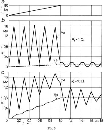
Spannungen an einer Anordnung gemäss Fig. 2 i Blitzstrom;  $R_{\rm e}$  Erdungswiderstand;  $u_{\rm A}$  Spannung zwischen A und C der Fig. 2;  $u_{\rm B}$  Spannung zwischen B und C der Fig. 2; t Zeit Weitere Bezeichnungen siehe Fig. 1 und im Text
