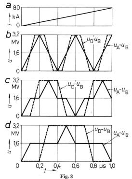
Spannungen an einer Anordnung gemäss Fig. 7 i Blitzstrom;  $u_{\rm A}$  —  $u_{\rm B}$  Spannung zwischen A und B der Fig. 7;  $u_{\rm D}$  —  $u_{\rm B}$  Spannung zwischen D und B der Fig. 7
