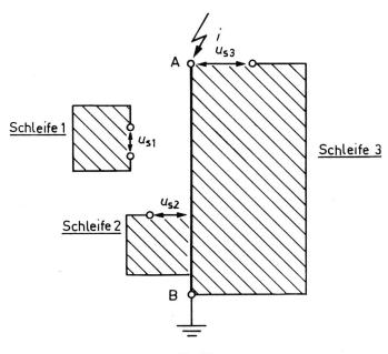
Fig. 12 Leiterschleifen in Ableiternähe u<sub>s</sub> Schleifenspannung Weitere Bezeichnungen siehe Fig. 1
