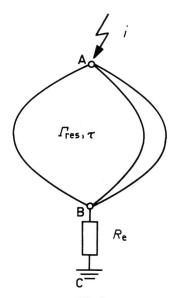
Fig. 2 Parallele Ableiter gleicher Länge  $\Gamma_{\rm res}$  resultierender Wellenwiderstand Weitere Bezeichnungen siehe Fig. 1
