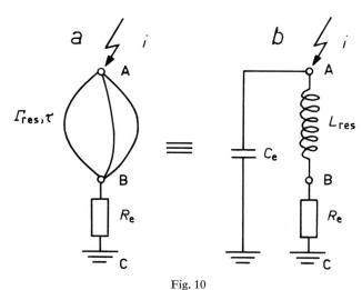
Vergleich der Ersatzschaltungen für parallele Ableiter  $L_{\rm res}$  resultierende Induktivität;  $\Gamma_{\rm res}$  resultierender Wellenwiderstand Weitere Bezeichnungen siehe Fig. 1 und Fig. 9
