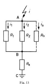
Stromaufteilung an Ableitern nach den Ohmschen Widerständen i<sub>1</sub>, i<sub>2</sub>, i<sub>n</sub> Teilströme; R<sub>1</sub>, R<sub>2</sub>, R<sub>n</sub> Ohmsche Ableiterwiderstände Weitere Bezeichnungen siehe Fig. 1
