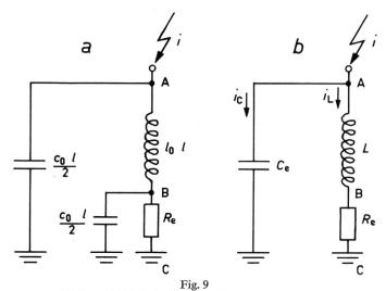
Ableiter als LC-Kreis mit Öhmschen Erdungswiderstand  $i_{\rm L}, i_{\rm C}$  Teilströme (A); L Induktivität (H);  $C_{\rm e}$  Verkettungskapazität zur Erde (F)
