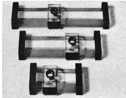
Ablesen ermöglicht. Die Maßstäbe von 50 bis 300 mm Länge haben einen, jene von 500 mm und länger zwei Plexiglasschieber, die auf Kunststoffrollen laufen, sehr leicht sind und ohne Maßstabverschiebung verschoben werden können. Eine Ableselupe am Schieber vergrößert 8fach.
