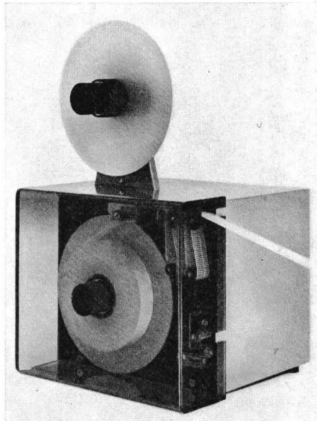
automatisch geregt. Die Streifenspannung bleibt stets gleichmässig. Sie beträgt normalerweise 40...45 g, kann aber durch Justieren auf 20...25 g reduziert werden. Das Gerät ist 255 mm hoch, 280 mm breit und 295 mm lang und wiegt 6,8 kg.
