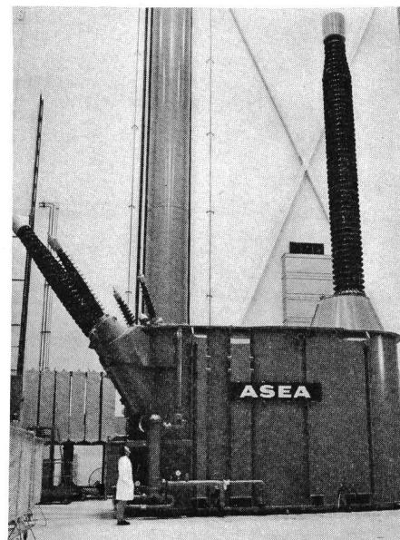
5 m hoch. Die gesamte Höhe bis zur Spitze der Durchführung beträgt 17,5 m. Sein Gewicht ist 290 t. Der Transformator dient zum Prüfen der wichtigsten Teile zukünftiger Drehstromübertragungssysteme mit Ultrahochspannungen. Als zweckmässigste Lösung für die Transformierung in Ultrahochspannungssystemen findet man die Verwendung von drei Einphasentransformatoren, die zusammen eine Leistung von 3000 MVA verarbeiten.
