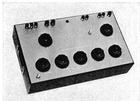
material mit einem extrem niedrigen und annähernd linearen Temperatur-Koeffizienten hergestellt werden. Mit dieser Brücke können auch in nicht klimatisierten Räumen im Temperaturbereich von 19...25 °C Absolut-Genauigkeiten von  $\pm 0,003\%$  oder 30 ppm erreicht werden. In einem engeren Temperaturbereich von 22...24 °C kann die Genauigkeit sogar auf 20 ppm erhöht werden.
