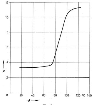
Fig. 10 Relative Dielektrizitätskonstante  $\varepsilon_{_{\Gamma}}$  in Abhängigkeit von der Temperatur von Hart-PVC
