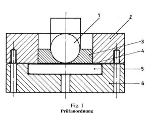
I Kugelelektrode mit Aufsatz zur Spannungszuführung;
