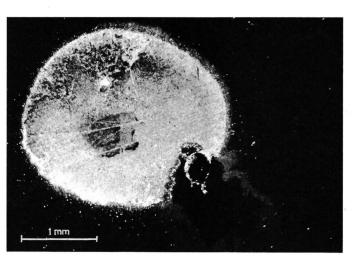
Fig. 5 **Hart-PVC-Folie nach Spannungsbeanspruchung**Hohlräume mit Palatinol AH gefüllt  $\tilde{U}_{\sim} = 21,2 \text{ kV}; t_{\text{d}} = 2 \text{ h}$
