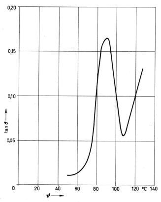
Fig. 11 Verlustfaktor  $an\delta$  in Abhängigkeit von der Temperatur von Hart-PVC
