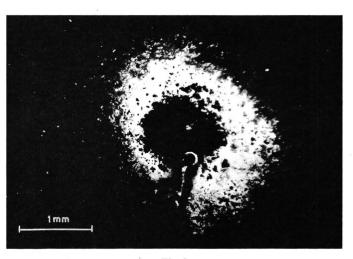
Fig. 2 Hart-PVC-Folie nach Spannungsbeanspruchung  $\hat{U}_{\sim}=10,2$  kV;  $t_{\rm d}=3$  h 4'
