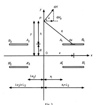
Fig. 3 Ersatz der Magnete durch Strombeläge  $A_1$ ,  $B_1$  und  $A_2$ ,  $B_2$  eintretende Ströme;  $A'_1$ ,  $B'_1$  und  $A'_2$ ,  $B'_2$  austretende Ströme; P Punkt, für den  $H_{\rm X}=0$  ist
