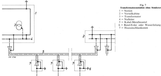
Fig. 7 Transformatorenstation ohne Sondererdung
