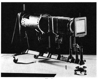
Fig. 8 Provisorische Vorrichtung (Goniometer) zur Messung von Streuvermögen  $\sigma$ und Halbwertswinkel  $\gamma$
