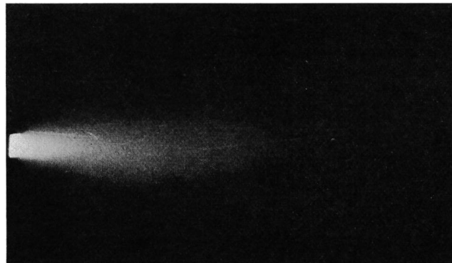
Fig. 2 Streuwirkung eines Mattglases in der Rauchkammer (Mikrostruktur)
