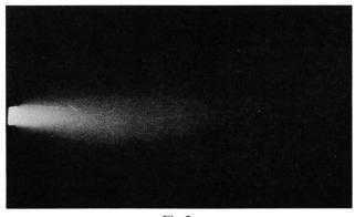
Fig. 2 Streuwirkung eines Mattglases in der Rauchkammer (Mikrostruktur)
