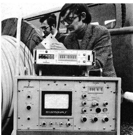
von Fehlerstellen. Mit dem Gerät lassen sich Fehler in Kabeln bis zu 75 km, in Freileitungen bis zu 150 km Entfernung nach dem Impuls-Reflexionsverfahren orten und genau einmessen. Mit einem elektronischen Kleinrechner werden die Messergebnisse ausgewertet. Die Fehlerstellenentfernung wird dabei in Metern digital angezeigt.
