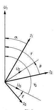
$Fig. \ 1 \\ \textbf{Zeigerdiagramm der symmetrischen Spannungs- und Stromkomponenten in} \\ \textbf{Phase R}$
