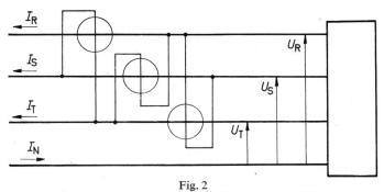
Kunstschaltung der Leistungsmesser für die Messung der Blindleistung  $I_{\rm R},\ I_{\rm S},\ I_{\rm T},\ I_{\rm N}$  unsymmetrisches Stromsystem;  $U_{\rm R},\ U_{\rm S},\ U_{\rm T}$  unsymmetrisches Spannungssystem
