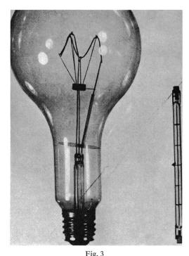
Grössenvergleich: Halogen-Glühlampe zu Normal-Glühlampe
