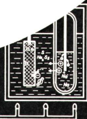
Naimon-Schwefel-Zelle der Firma Ford. Die Na + -Ionen (I) wandern durch die Keramik. Die Elektronen (e) wandern über die negative Elektrode.
