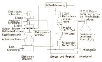
Fig. 1 Blockschema des Elektronenstrahl-Systems
