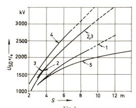
Fig. 1 50-%-Überschlagspannung von Luftabständen verschiedener Typen in Abhängigkeit ihrer Länge (Schlagweite S) bei Schaltspannungen mit einer Frontdauer von 2500...4000 µs
