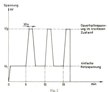
Spannungszyklen, denen die Isolatoren nach der Alterung ausgesetzt werden
