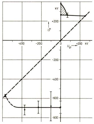
Für die positiven Stoßspannungen tritt mit dem Einsetzen der Vorentladung durch die Gleichspannung eine Spannungsabsenkung ein.
