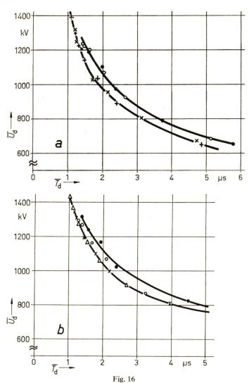
Einfluss der Höhe der Gleichspannung auf die Stosskennlinie der 100-cm Stab-Stab-Funkenstrecken
