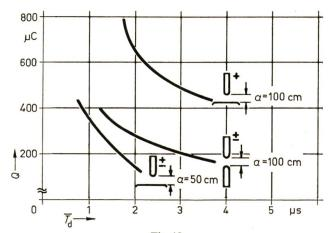
Fig. 18 Ladungskennlinien in Abhängigkeit von der Durchschlagzeit Parameter: Anordnung
