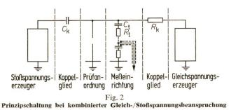
Prinzipschaltung bei kombinierter Gleich-/Stoßspannungsbeanspruchung  $C_k$  Koppelkondensator 48 nF;  $C_t$  Teilerkapazität 291 pF;  $R_k$  Koppelwiderstand 4 M $\Omega$ ;  $R_t$  Teilerwiderstand 758  $\Omega$
