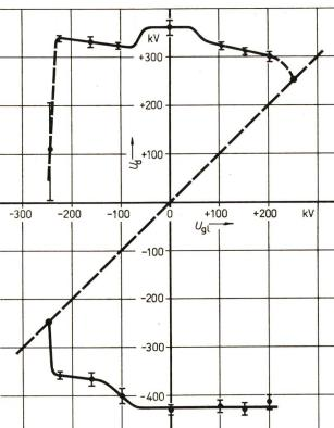
konstantem Abstand ( $a=25~\rm cm$ ) für die Stab-Platte-Funkenstrecke nachgewiesen werden (Fig. 8). Als Elektrodenabschluss wird die 2-cm-Halbkugel, die 30°-Spitze und die stumpfe Elektrode verwendet. Die Existenzbereiche der bei Gleichspannung möglichen Vorentladungen sind sehr verschieden.
