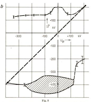
Durchschlagspannung einer 25-cm-Stab-Platte-Funkenstrecke bei Überlagerung von Gleich- und Stoßspannung 1,2 | 50
