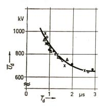
Fig. 17 Einfluss der Höhe der Gleichspannung auf die Stosskennlinie der negativen 50-cm Stab-Platte-**Funkenstrecke**
