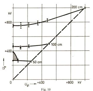
Durchschlagspannung von Stab-Platte-Funkenstrecken bei Überlagerung von Gleich- und Stoßspannung 60 | 525
