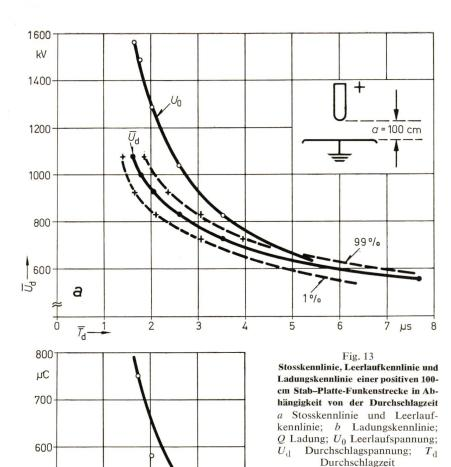
durch die Addition eines konstanten Betrages auf den Zeitnullpunkt umgerechnet. Jeder Punkt der Stosskennlinie ist aus mindestens 10 Spannungsbeanspruchungen nach statistischen Methoden ermittelt.
