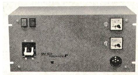
strom z. B. mit Thyristoren auf Grund des Phasenanschnittprinzips zu steuern.
