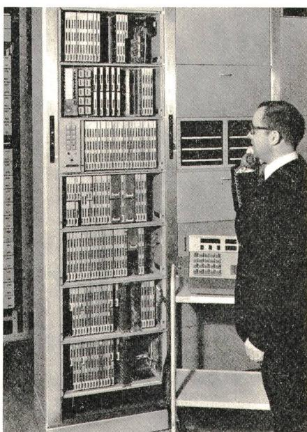
wo sie gespeichert werden. Die Weckvorgänge werden von 10 «automatischen Telefonistinnen» ausgeführt. Sprache und Zeitimpulse werden von einer Mutteruhr einer Sprechmaschine und der sprechenden Uhr zugeführt.
