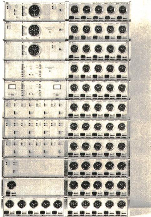
Sekunde pro Jahr. Zum Vergleich: die Erde dreht sich mit Abweichungen bis zu 1/100 Sekunde pro Tag! Diese Präzision wird durch drei Quarzoszillatoren (mit je 10 000 Schwingungen pro Sekunde) und eine automatische Korrektur durch das Zeitsignal des Senders Prangins (das seinerseits von der Atomuhr des Observatoriums Neuenburg gesteuert wird). Schliesslich hat die Hauptuhr noch einen elektronischen Schutzautomaten; bei der geringsten Unregelmässigkeit werden Reservegeräte eingeschaltet.
