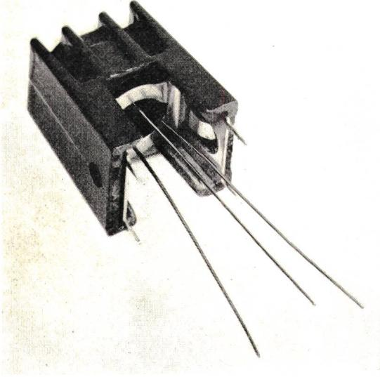
wird hauptsächlich im Zusammenhang mit gedruckten Schaltungen verwendet. Der dreiteilige Aufbau des Kühlsystems ergibt auf kleinstem Raum günstige thermische Widerstandswerte ( $0,04 \text{ }^{\circ}\text{C}/\text{mW}$ ).
