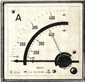
Kombinierter Dreisehen-Bimetall-Strommesser\* (96 × 96 mm)
