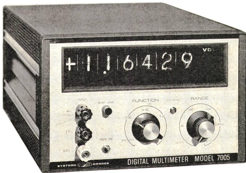
Dieses Digital-Voltmeter mit 5½ Anzeigeziffern gestattet standardmäßig die Gleichspannungsmessung mit einer Auflösung von  $10 \mu\text{V}$  bei einer Unsicherheit von  $\pm 0,005\%$ .
