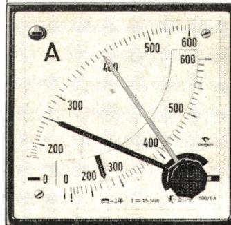
Kombinierter Bimetall-Dreiseiten-Strommesser (96 × 96 mm)
