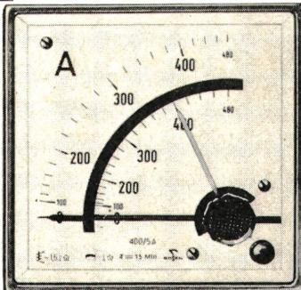
Kombinierter Dreiseiten-Bimetall-Strommesser\* (96 × 96 mm)
