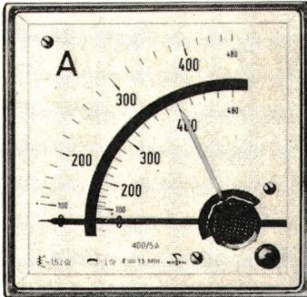
Kombinierter Dreisehen-Bimetall-Strommesser\* (96 × 96 mm)
