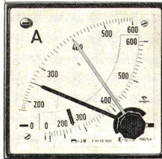
Kombinierter Bimetall-Dreisehen-Strommesser (96 × 96 mm)
