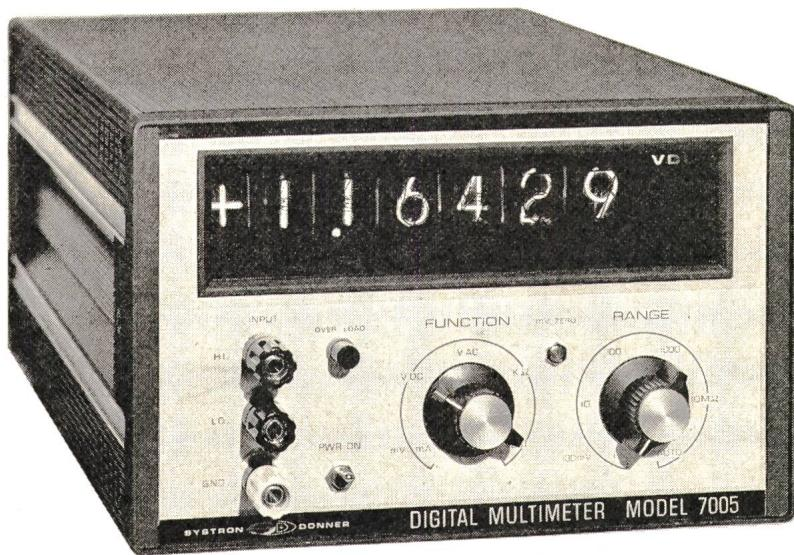
Dieses Digital-Voltmeter mit 5½ Anzeigeziffern gestattet standardmäßig die Gleichspannungsmessung mit einer Auflösung von 10 µV bei einer Unsicherheit von  $\pm 0,005\%$ .
