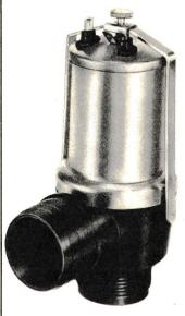
Das elektromagnetische Ablaufventil wird eingesetzt, um Wasserbehälter, Entwässerungsanlagen, Zu- und Ableitungen für Chemikalien zu entleeren oder zu steuern. Luftströme und Gase können ebenfalls zu- oder abgeschaltet werden. Das Unterteil aus Zwei-Komponenten-Kunststoff und hochwertigem Kunstgummi für den Schliesskörper ermöglicht den Einsatz bei aggressiven Medien.
