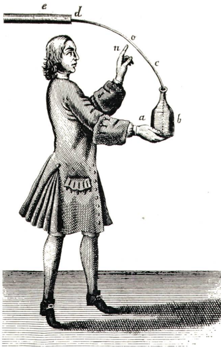
Fig. 2 Das Musschenbroeksche Experiment nach einer Darstellung von Winkler [3]
