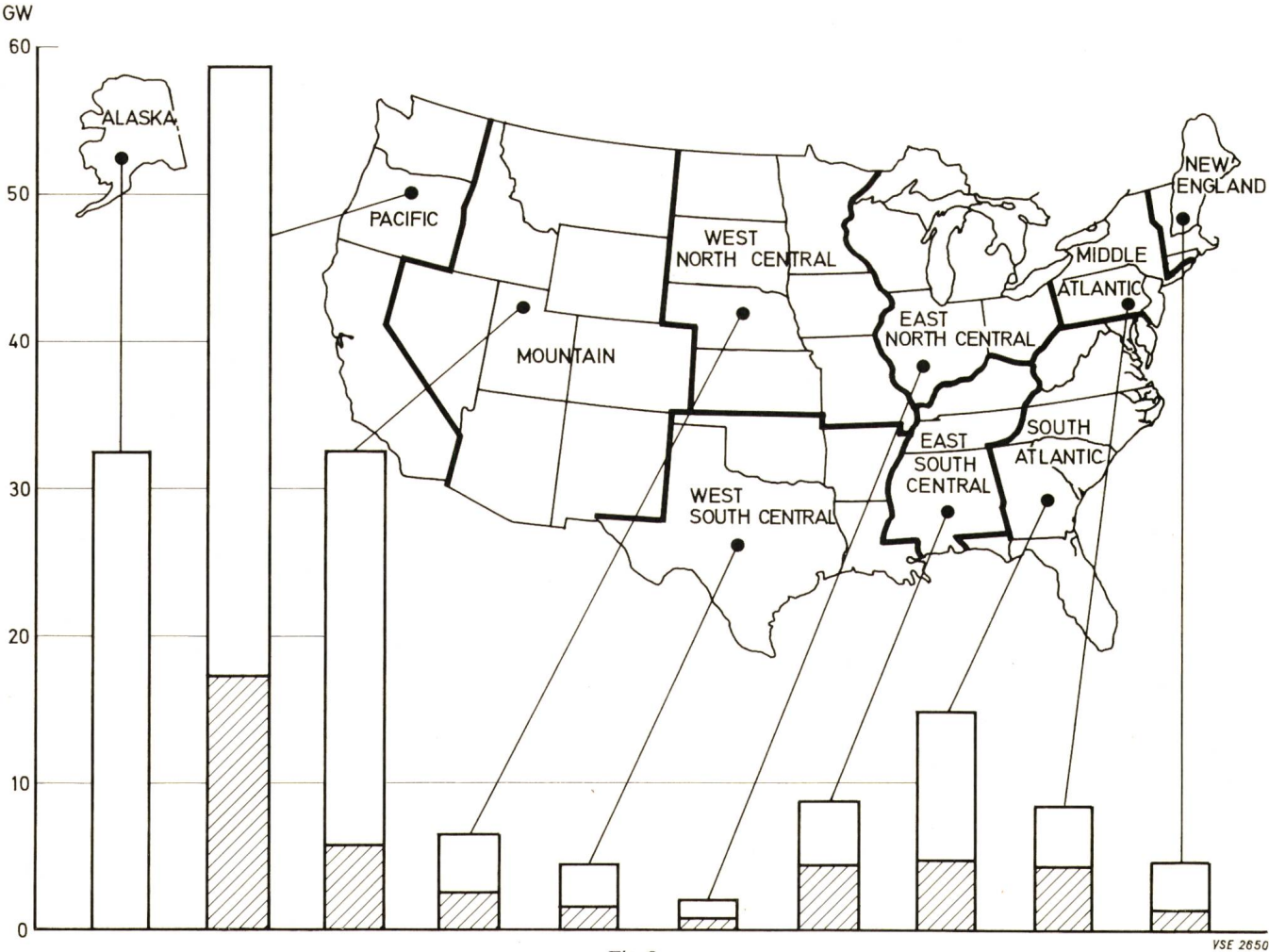
Fig. 8 Die Wasserkräfte der USA Die schraffierten Kolonnen deuten die erschlossenen Wasserkräfte an (nach dem Stand von 1967)
