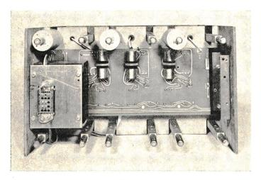
Fig. 24 **Rückseite des Einschubs der Fig. 23** Links unten der Impulstransformator
