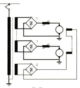
Fig. 12 Speisung und Steuerung der Erregung eines Traktionsmotors mit separater Erregung
