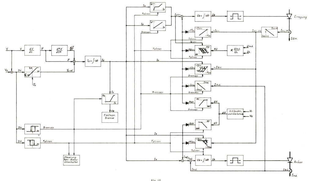
Fig. 15 Blockschema der elektronischen Steuerung der Geschwindigkeit für Triebwagen der rhätischen Bahn
