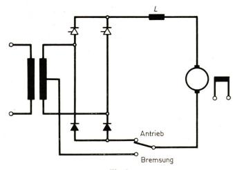
Fig. 6 Anwendungsschema einer symmetrischen Brücke für die Rekuperations-Bremsung
