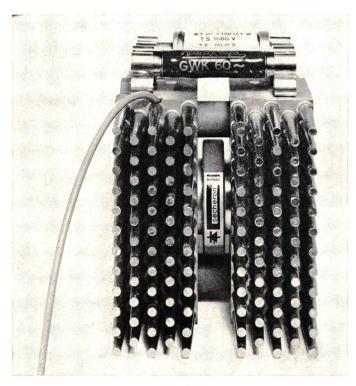
Fig. 20 Scheibenthyristor zwischen zwei Kühlköpfen von Typ «Herisson» montiert
