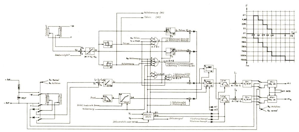
$Fig.~16\\ \textbf{Blockschema des Geschwindigkeitsreglers und des Stromes einer BB Lokomotive mit Thyristoren}\\ CI~\text{angezeigter Strom}\\ VI~\text{angezeigte Geschwindigkeit}$
