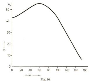
Amplitude der 2. Harmonischen der gleichgerichteten Spannung in Funktion der Summe der Kommutations- und Steuerwinkel
