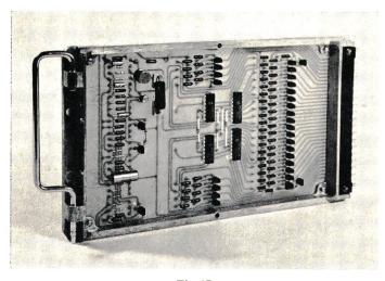
Fig. 17 Steckkarte der Steuerelektronik mit integrierter Schaltung
