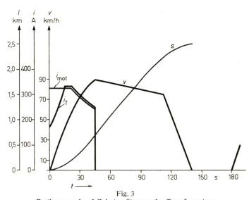
Bestimmung des definierten Stromes des Transformators  $i_{\mathrm{mot}}$  Läuferstrom für einen Motor;  $i_{\mathrm{T}}$  Strom in der Sekundärwicklung;
