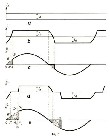
Wechselspannung und -strom in einer Gleichrichterbrücke
