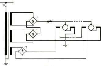
Fig. 13 Speisung und Steuerung der Erregung eines Traktionsmotors in Compoundschaltung 1 Hauptbrücke; 2 Erregerbrücke
