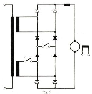
Anwendungsschema zweier symmetrischen Brücken für Rekuperations-Bremsung
