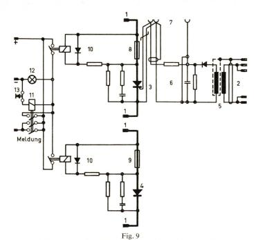
Beispiel einer Schutzschaltung für Dioden und Thyristoren
