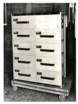
Fig. 21 Vollständiger Gleichrichter eines Triebwagens BB 1000 der rhätischen Bahnen (Schweiz)
