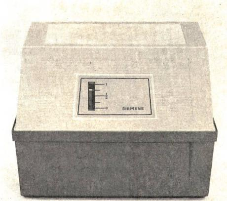
selte Filterwand saugt ein kaum hörbar laufender Ventilator Raumluft an. Sie nimmt dabei so viel Feuchtigkeit auf, wie sie ihrer Temperatur entsprechend tragen kann, wird «zugfrei» nach oben in den Raum abgegeben und vermischt sich dort mit der trockenen Luft. Ein Wasserstandsanzeiger gibt die verfügbare Wassermenge an.
