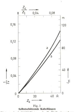
a33-kV-Unterwerk; b66-kV-Unterwerk;  $Z_{\rm c}$ Wellenimpedanz des Kabels, die untere Abszisse gilt für  $Z_{\rm l}=487~\Omega;~Z_{\rm l}$ Wellenimpedanz der Freileitung; tDauer der einfallenden abgeschnittenen Stosswelle; vWellengeschwindigkeit im Kabel;  $l_{\rm m}$ minimale selbstschützende Kabellänge
