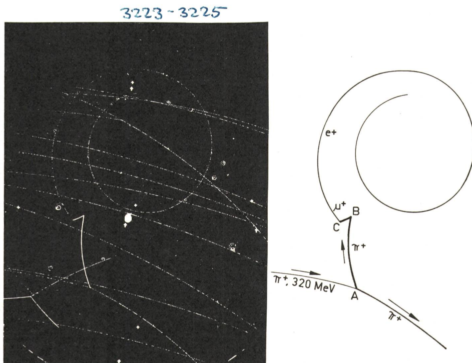
Fig. 1 Spuren von der Entstehung eines Pi-Mesons (A) und seiner Zerfallskette: Pi-Meson (A bis B) → Muon (B bis C) → Positron (Spiralbahn). Aufnahme in einer Wasserstoffblasenkammer der CERN
