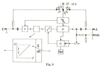
Funktionsschaltbild eines Breitbandverstärkers E Eingang; MA Messausgang; A Ausgang
