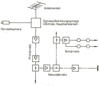
Fig. 1 Prinzipieller Aufbau eines grossen VHF-Verteilnetzes
