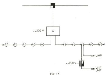
Verteilverstärker in Breitbandtechnik und Empfänger-Konverter für den Zwischenbereich
