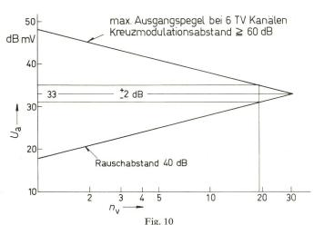
Pegeldiagramm eines Verstärkers für die Erkennbarkeitsgrenzen der Kreuzmodulation und des Rauschens bei 6 TV-Programmen gleicher Pegel (Kaskadeabilität)
