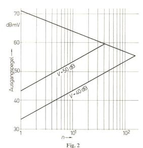
Kaskadeabilitätsdiagramm eines geregelten Leitungsverstärkers für die Übertragung von zwei Fernsehprogrammen im Frequenzbereich 5...22 MHz (Kreuzmodulationsabstand 52 dB, Rauschabstand 46 dB, Verstärkung 50 dB bzw. 40 dB, totale Kaskadeabilität 2000 dB bzw. 6000 dB)
