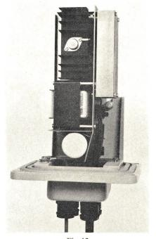
Fig. 12 Netzteil eines Breitbandverstärkers ohne Gehäusekappe
