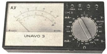
Denn einer muß rasch hohe Gleichspannungen prüfen, im nächsten Augenblick ganz geringe Wechselströme messen und dann vielleicht unbekannte Widerstände identifizieren. Er wird das UNAVO vorziehen mit seinen 24 schnell schaltbaren Meßbereichen.
