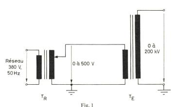
Schéma de principe de l'installation d'essais
