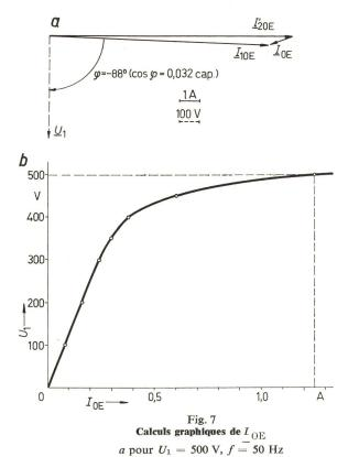
$I'_{20\,\mathrm{E}}$  courant dû à la capacité propre de l'enroulement secondaire;  $\bar{I}_{10\,\mathrm{E}}$  courant magnétisant calculé d'après les caractéristiques magnétiques;  $\bar{I}_{0\,\mathrm{E}}$  courant primaire à vide du transformateur d'essais. (Il s'agit des valeurs efficaces des courants  $\mathrm{i}'_{20\,\mathrm{E}}$ ,  $\mathrm{i}_{10\,\mathrm{E}}$  et  $\mathrm{i}_{0\,\mathrm{E}}$  de la fig. 4)
