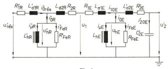
Fig. 4 Schéma équivalent simplifié
