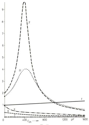
Fig. 13 Comportement de l'installation équipée d'un filtre pour l'harmonique 7 ( $L_{\rm f}=4$  mH,  $C_{\rm f}=50$  µF), en charge capacitive Les numéros des courbes sont explicités à la fig. 11
