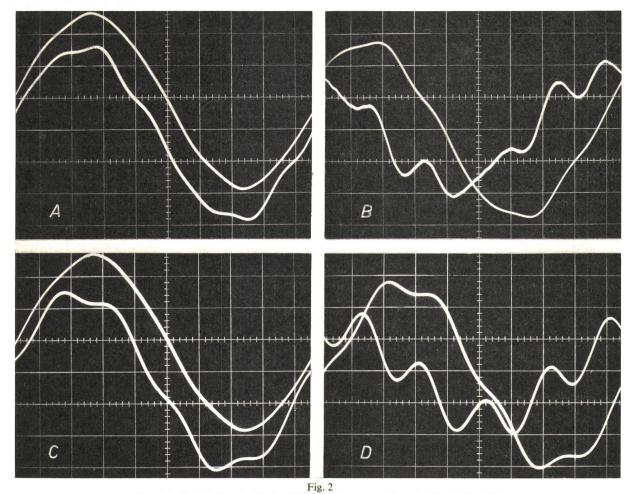
Essai de l'installation, à vide (A et B) et en charge capacitive de 400 pF (C et D)
