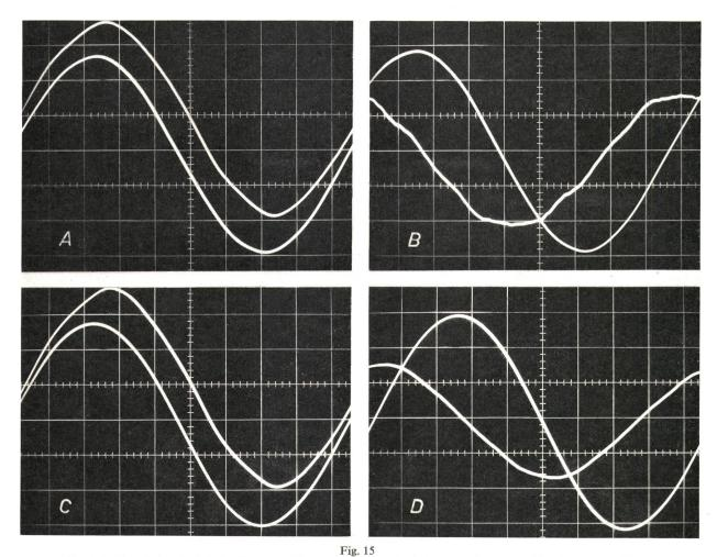
Essai de l'installation équipée du filtre pour l'harmonique 5, à vide (A, B) et en charge capacitive de 400 pF (C, D)
