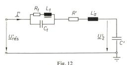
Schéma équivalent de l'installation équipée d'un filtre (circuit-bouchon)  $C_{\rm f}$  capacité du filtre;  $L_{\rm f}$  inductance du filtre;  $R_{\rm f}$  résistance de la bobine d'inductance
