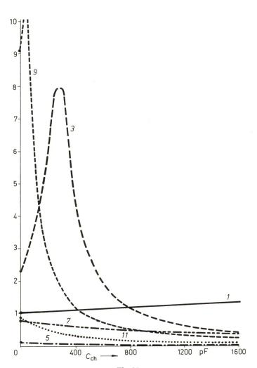
Fig. 14 Comportement de l'installation équipée d'un filtre pour l'harmonique 5 ( $L_{\rm F}=4$  mH,  $C_{\rm F}=100$  µF) en charge capacitive Les numéros des courbes sont explicités à la fig. 11
