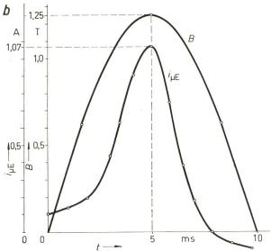
Fig. 8 Allure du courant magnétisant  $i_{\mu R}=f(t)$ , obtenu à l'aide de la caractéristique magnétique 5a
