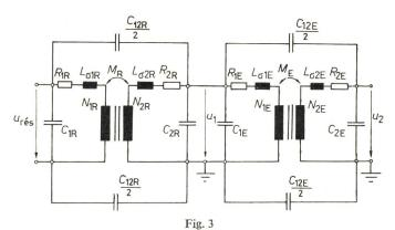
Schéma équivalent complet de l'installation «à vide»
