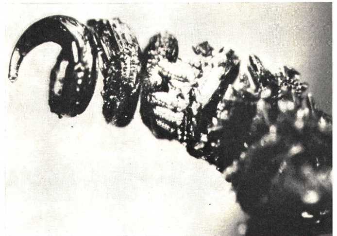
Fig. 9 Maximale Wolframablagerung an einer Doppelwendel in der Wirbelachse Übergang zwischen Wendelhalterung und der ersten Doppelwindung
