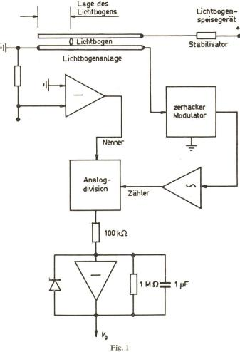
Analogmesseinrichtung zwischen Lichtbogen und Digitalrechner
