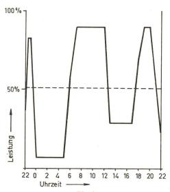
Fig. 1 Der Schwelltrieb der Ennskraftwerke
