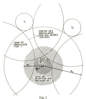
Les trois zones d'influence d'un émetteur de télévision T émetteur considéré;  $T_1$ ,  $T_2$  émetteur du même canal;  $R_1$  rayon de la zone de service;  $R_2$  rayon de la zone de service non protégée;  $R_3$  rayon de la zone de brouillage
