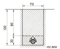
Kabelverlegung 1×(3×120<sup>2</sup>) PPbO-TF 60 kV
