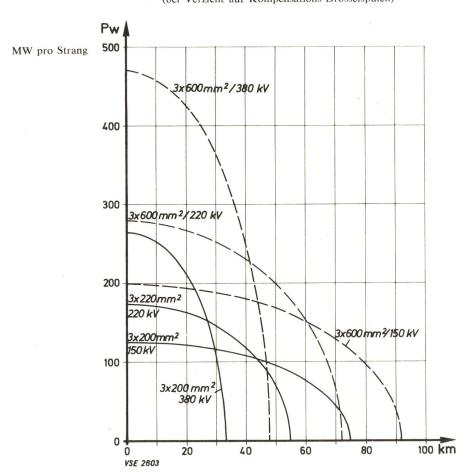
Bei der maximalen Leitungslänge ist die Blindstromaufnahme des Kabels so gross, dass seine zulässige Belastbarkeit total durch den Blindstrom beansprucht wird, so dass für die Übertragung der Wirkleistung keine Übertragungsfähigkeit verfügbar bleibt.
