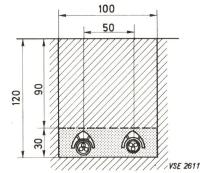
Kabelverlegung 2×(3×240²) PPbO-TF 60 kV
