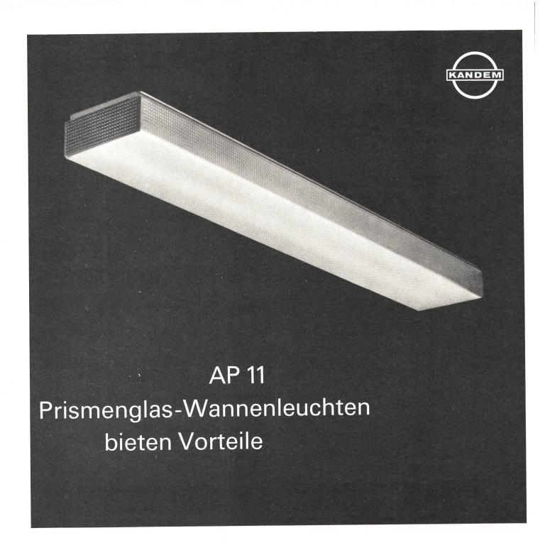
in der vereinfachten Montage durch nur eine Person, in den vielseitigen Einsatzmöglichkeiten als Decken-, Pendel-, Eck- und Wandleuchten in Einzel- oder Reihenmontage, Lampenträger Stahlblech aus einem Stück geprägt, weiß thermolackiert, Pyramid-Prismenglaswanne innensatiniert, mit Standard-Fluoreszenzröhren Farbe 33 ausgerüstet. Verlangen Sie unsere ausführliche Unterlage 10.19 über Kandem-Leuchten.
