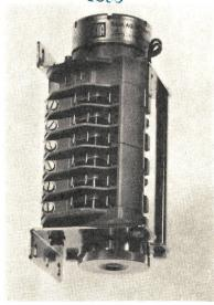
preisgünstige Großserien vorgesehen. Der Typ KKB4 (s. Fig.) ist eine Ausführung mit einzeln auswechselbaren Kontakten durch Lösen einer einzigen Schraube. Die Schaltleistung beträgt 6...15 A, 380 V. Die Programmscheiben sind in Schritten von nur 0,5 % der Programmdauer einstellbar.
