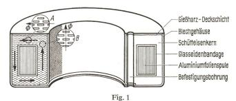
Schüttringdrosselspule mit Aluminiumfolienspulen A Längsgeblechter Teil; B Quergeblechter Teil
