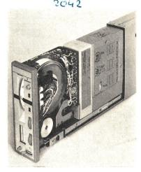
Das Leitgerät speichert die vom Rechner ermittelten Stelloder Sollwerte, wobei es sich um Absolut- oder Differenzwerte handeln kann. Im weiteren übernimmt das Leitgerät die Führung von Schaltfunktionen, wie die Umschaltung Hand-Automatic. Bei DDC mit analogen Reservereglern erfolgt die Umschaltung von Rechner- auf Regelbetrieb und umgekehrt stossfrei.
