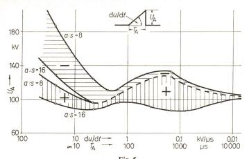
Fig. 5 Ansprechspannung  $U_{\rm A}$  der Stab-Stab-Funkenstrecke in Funktion der Frontsteilheit  ${\rm d}u/{\rm d}t$  oder der Ansprechzeit  $T_{\rm A}$  mit a:s=16 bis a:s=8
