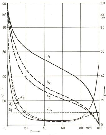
$\label{eq:Fig. 4} {\bf Fig. \ 4} \\ {\bf Spannungsverlauf} \ U \ {\bf und} \ {\bf Feldstärkenverlauf} \ E \ {\bf in} \ {\bf der} \ {\bf Achse} \ x \ {\bf der} \ {\bf Stab-Stab-Stab-Funkenstrecke}$
