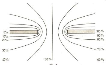
Fig. 2 Feldverteilung an der symmetrischen Stab-Stab-Funkenstrecke bei  $a: s = \infty$  Bezeichnungen siehe im Text
