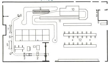
Fig. 1 Grundriss der Leuchtenfabrikation mit Arbeitsflußschema
