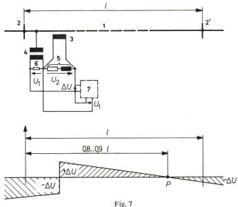
Distanzprinzip mit Leitungsabbild bei einem klassischen Distanzrelais I geschützte Leitungen; 2, 2' Sammelschiene; 3 Stromwandler; 4 Spannungswandler; 5 Leitungsabbild; 6 Widerstand; 7 Distanzrelais;  $U_1$  Polarisationsspannung;  $U_2$  Abbildspannung;  $\Delta U$  Differenzspannung= Relaisarbeitsspannung; I Leitungslänge; P Staffelpunkt (Grenze der 1. Zone in Richtung Leitung)
